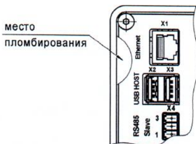
Рисунок 2 - Схема пломбировки от несанкционированного доступа
