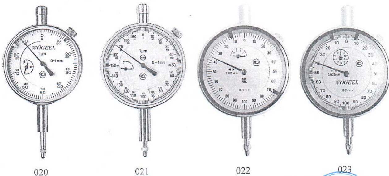
Рисунок 3 – Общий вид индикаторов ИЧ артикулы 020-023
