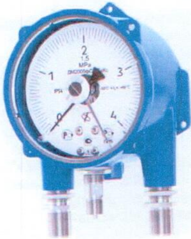
Манометр ДМ 2005фСг1Exd с маркировкой 1Ex d [ia] ia ПВ Т4 Gb
