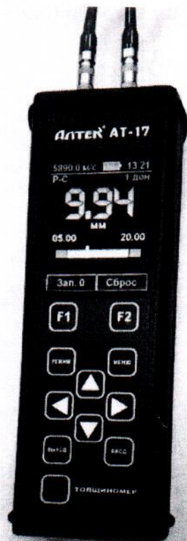
Рисунок 1 - Общий вид электронного блока толщиномеров
