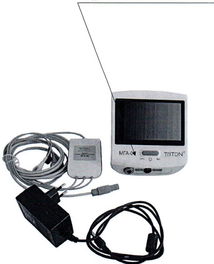
Рисунок А.1– Место нанесения знака поверки в виде клейма-наклейки на мониторы оценки глубины анестезии МГА-06
