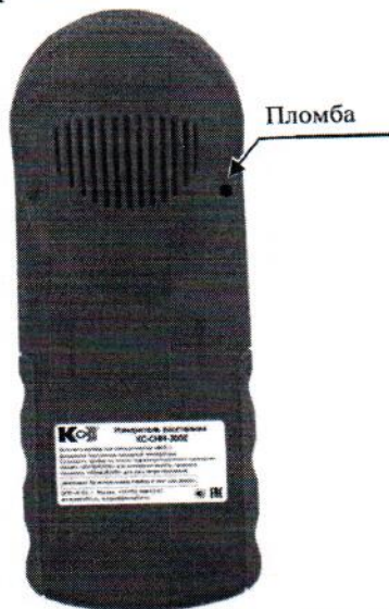
Рисунок 3 - Схема пломбировки от несанкционированного доступа измерителей КС-СНМ-600А
