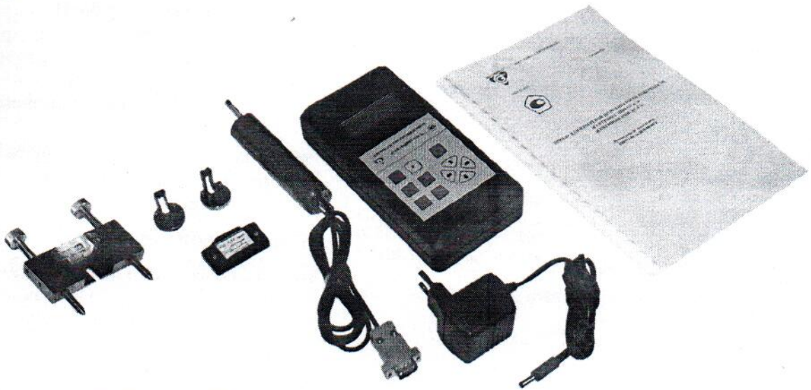
Рисунок 1 – Общий вид приборов для измерений шероховатости поверхности Сейтроник ПШ8-1(С.С.)
