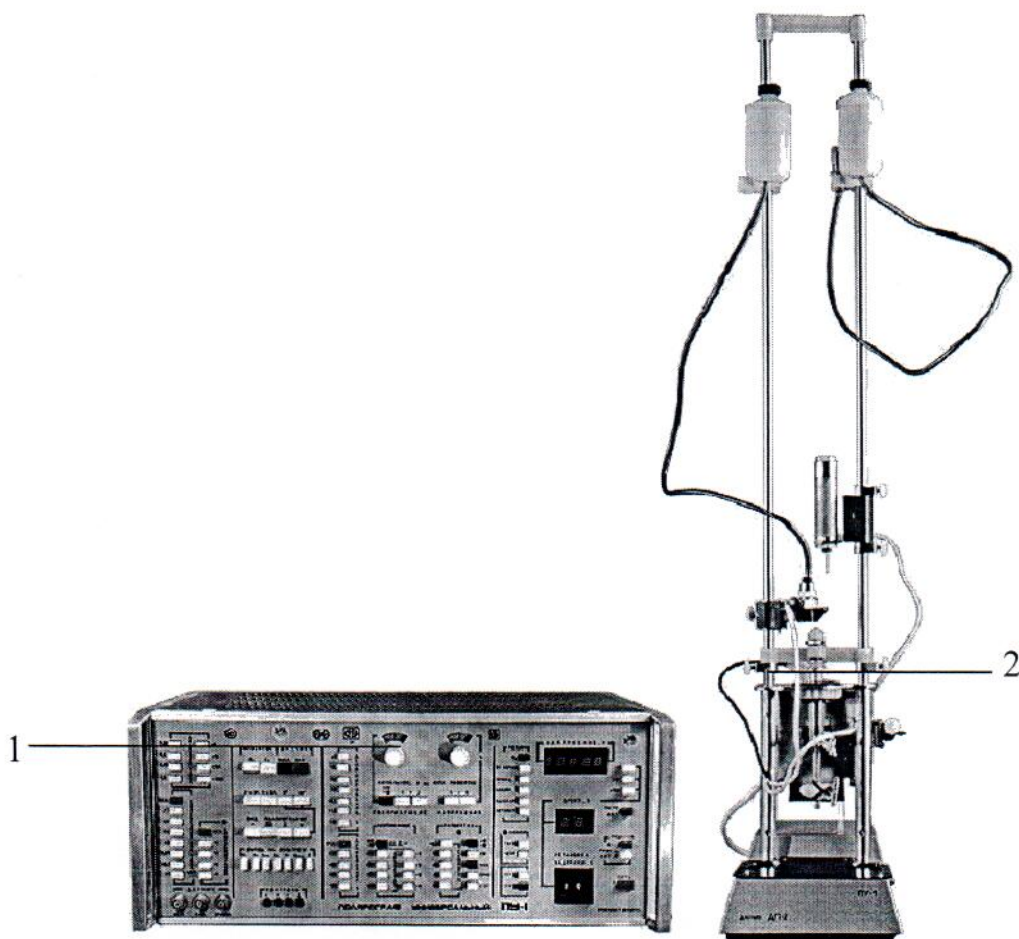
1 – измерительный блок; 2 – полярографический датчик ДП-2
