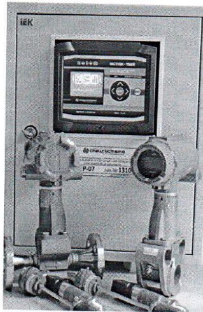
Рисунок 2 – Внешний вид СИ ИСТОК на базе вычислителя ИСТОК-ТМз
