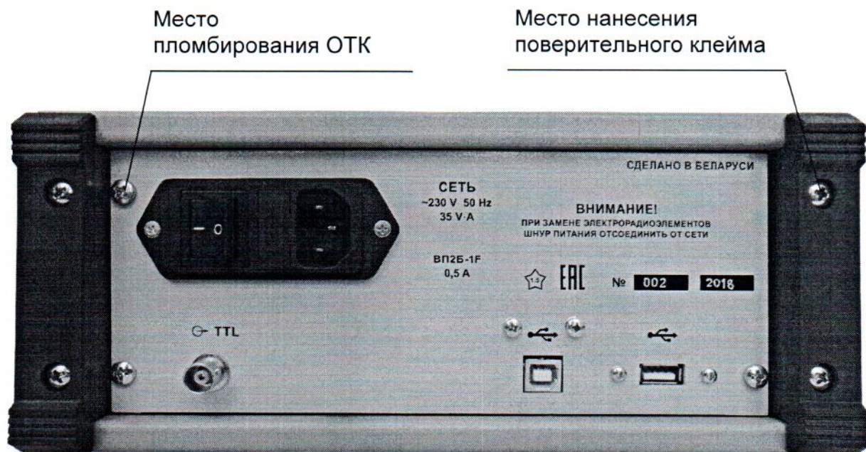
Рисунок А.1 – Место пломбирования ОТК и нанесения поверительного клейма (вид генератора сзади)
