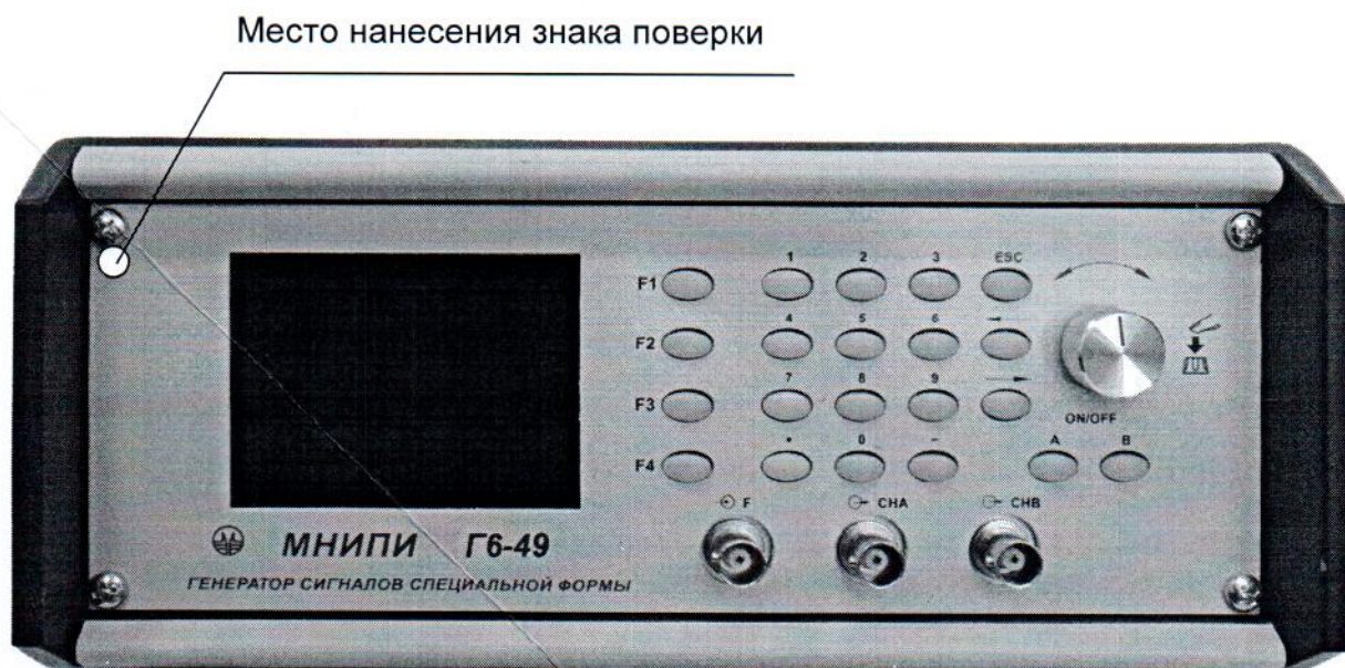
Рисунок А.2 – Место нанесения знака поверки (клейма-наклейки) (вид генератора спереди)
