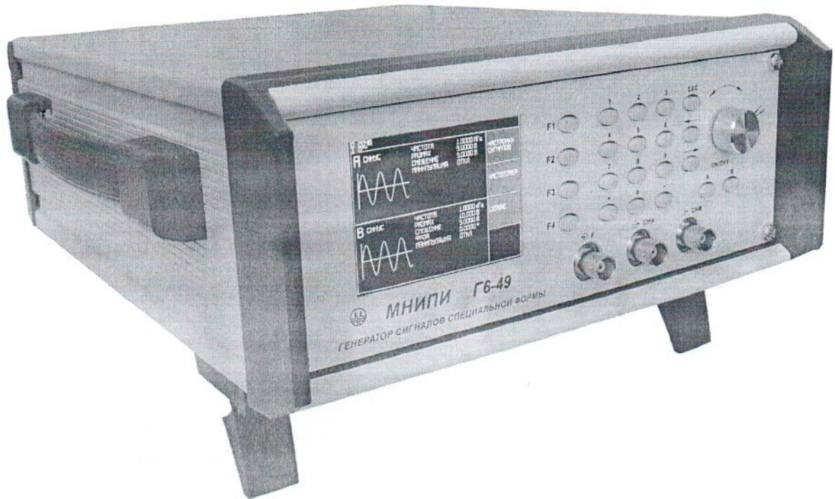
Рисунок 1 – Генератор сигналов специальной формы Г6-49. Внешний вид
