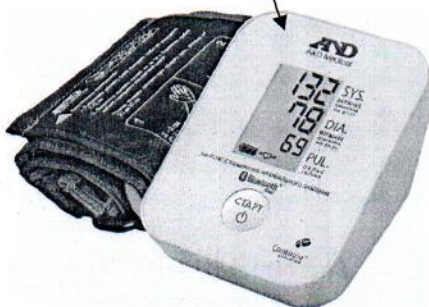
Рисунок А.1 – Место нанесения знака поверки (клейма-наклейки)
