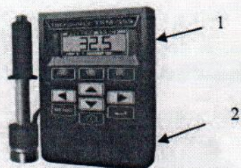
Рисунок 3. - схема пломбировки модификации ТКМ-359М 1,2-места пломбировки
