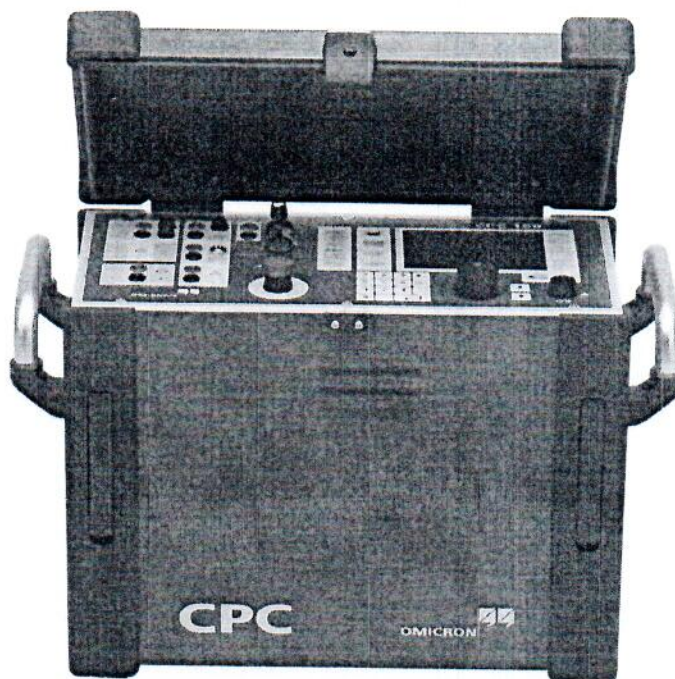
Рис. 1 Внешний вид комплекса измерительного многофункционального CPC 100.
