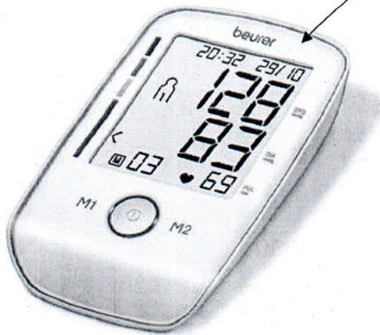
Рисунок 1.А – Место нанесения знака поверки (клеймо-наклейка)
