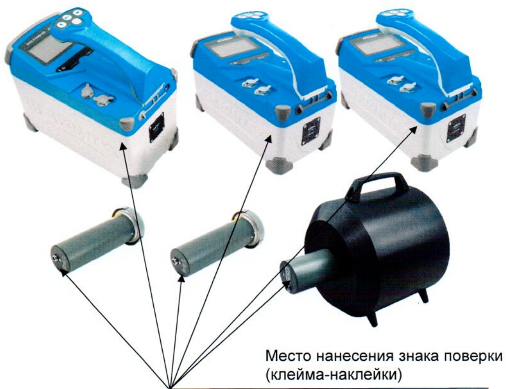
Рисунок 3 – Схема с указанием места нанесения знака поверки (клейма-наклейки)
