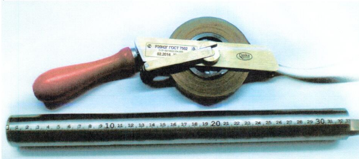
Рисунок 1 Внешний вид рулеток, соответствующих ГОСТ 7502
