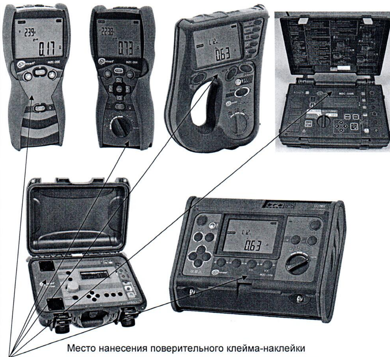
Рисунок А.1 – Место нанесения поверительного клейма-наклейки
