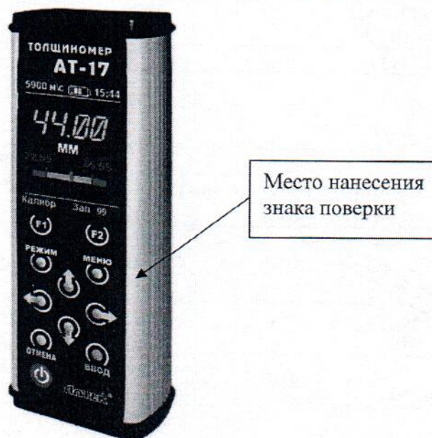
Рисунок 1 - Общий вид электронного блока толщиномеров
