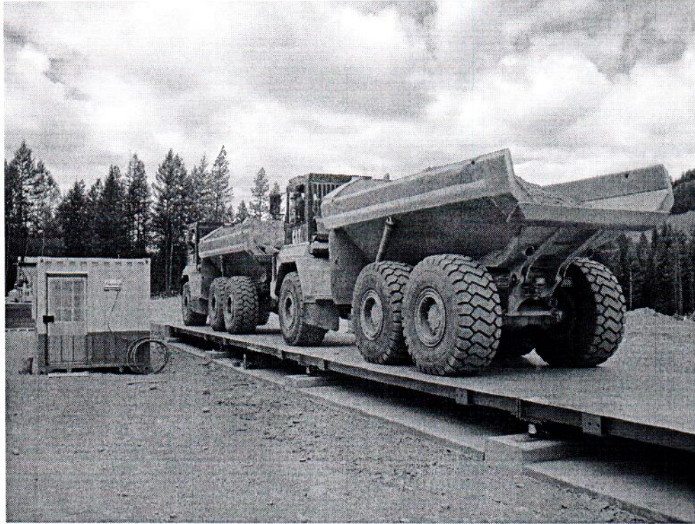
Рисунок 2 – Внешний вид весов, установленных на поверхности, с заездом по пандусу
