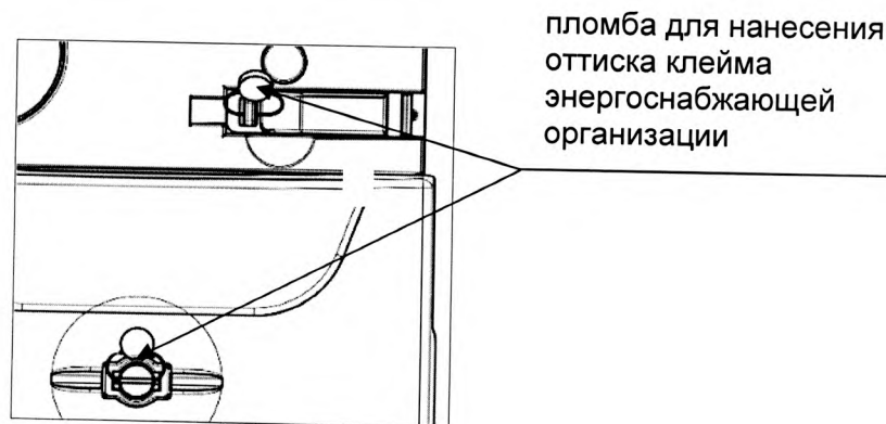
Рисунок А.3 – Место пломбирования энергоснабжающей организации счетчиков модификации «Гран-Электро СС-301-Х.ХХХХХ(ХХХХ)N» (вид с установленной крышкой зажимов)
