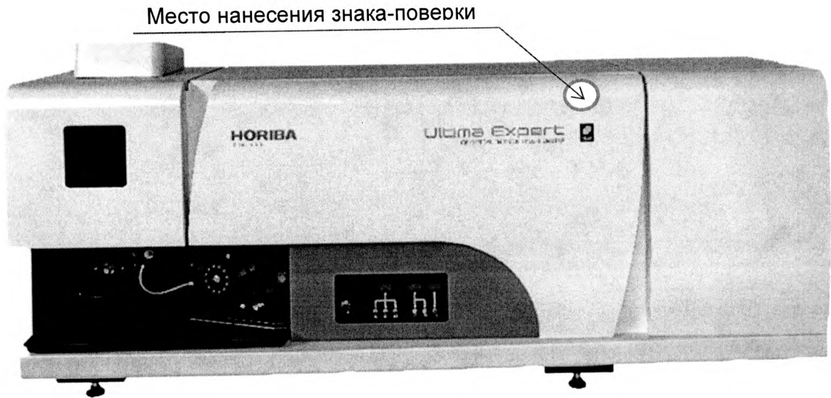
Рисунок А.1 – Схема нанесения знака-поверки в виде клейма-наклейки на спектрометры
