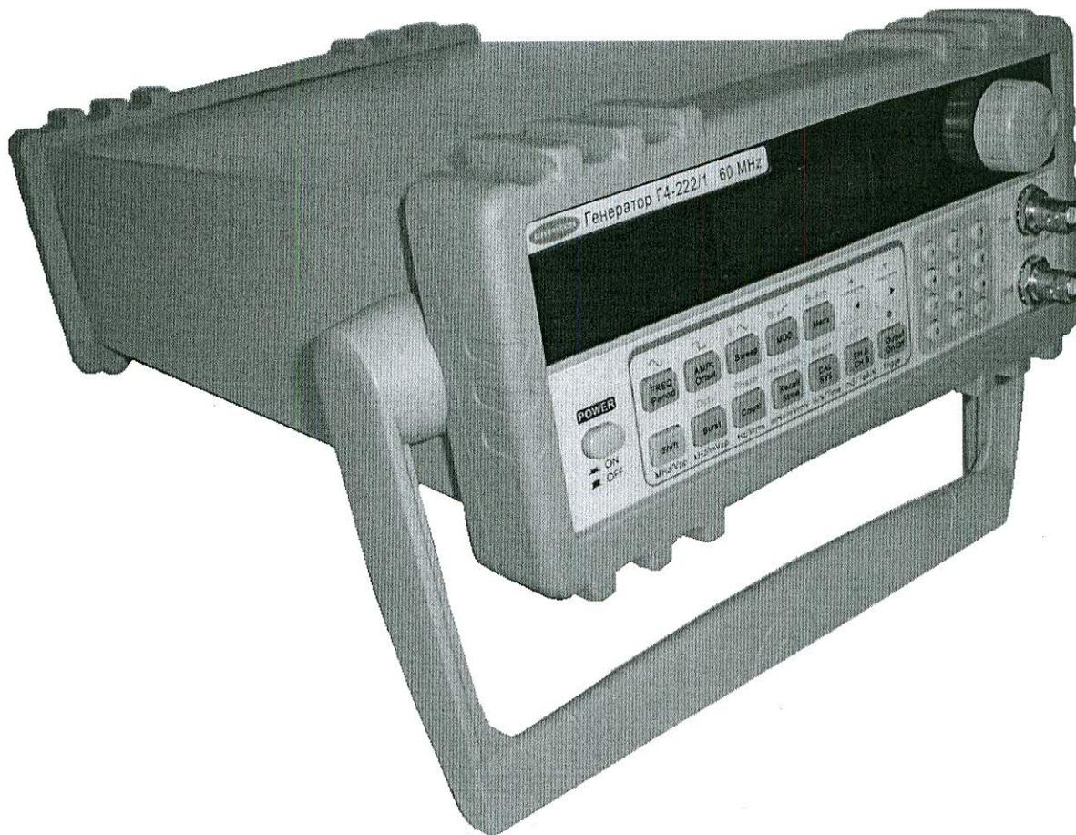
Рисунок 1 – Генератор сигналов высокочастотный Г4-222/1. Внешний вид
