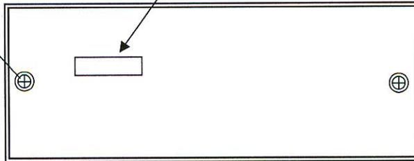
Рисунок А.1 – Место нанесения оттиска знака поверки и знака поверки в виде клейма-наклейки (вид генератора сзади)
