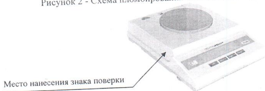
Рисунок 3 – Обозначение места нанесения знака поверки.
