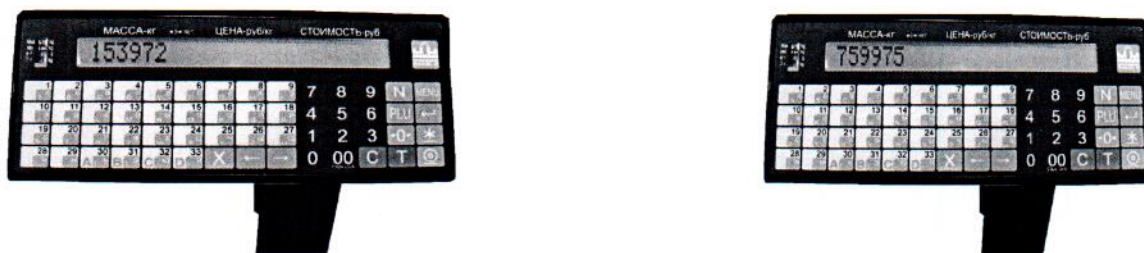
Рисунок 5 – Индикация кода юстировки
