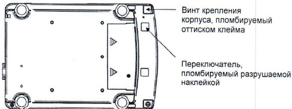
Рисунок 2 – Схема пломбирования весов от несанкционированного доступа
