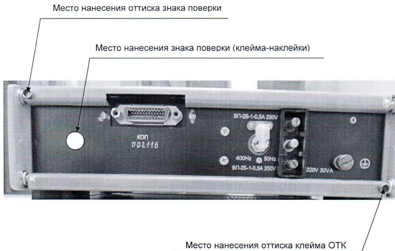
Рисунок А.1 – Схема пломбирования вольтметра от несанкционированного доступа с указанием мест нанесения знака поверки в виде клейма-наклейки, оттиска знака поверки, оттиска клейма ОТК
