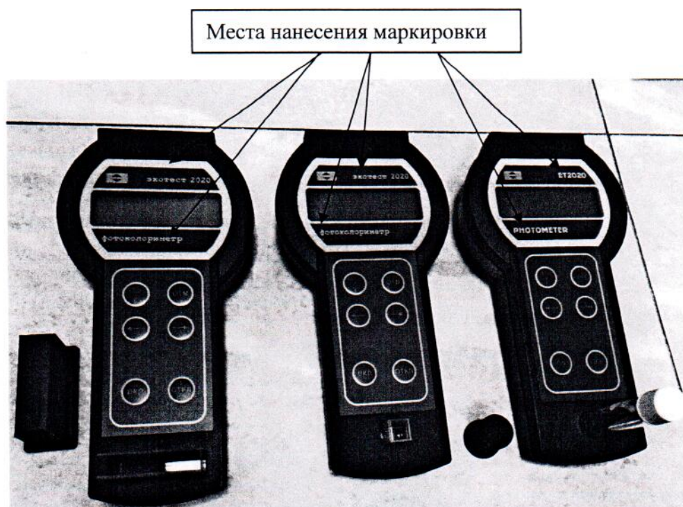
Рисунок 1 - Общий вид фотоколориметров «ЭКОТЕСТ-2020» с обозначением мест нанесения маркировки
