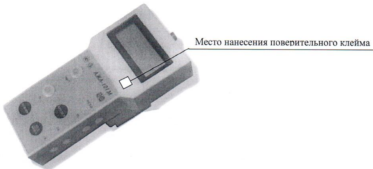
Рисунок А.1 – Схема нанесения на преобразователь знака поверки
