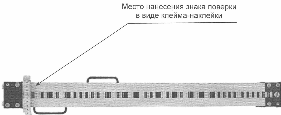
Рисунок А.2 – Место нанесения знака поверки в виде клейма-наклейки на рейку
