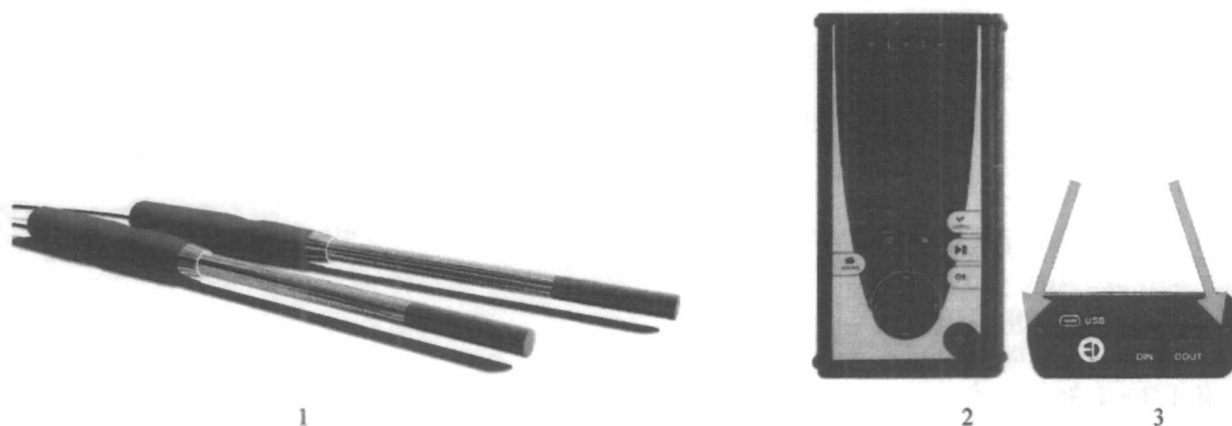
Рисунок 1 – Общий вид измерителя: 1 – измерительные зонды, 2 – индикаторный блок (лицевая панель); 3 – индикаторный блок (вид снизу); стрелками обозначены места пломбирования корпуса индикаторного блока измерителя
