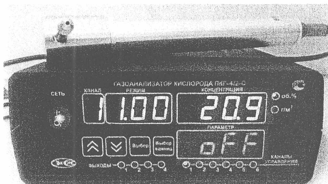
в) исполнение ПКГ-4/2-С-K-4P-2A (двухканальный, на фото показан только один измерительный преобразователь)
