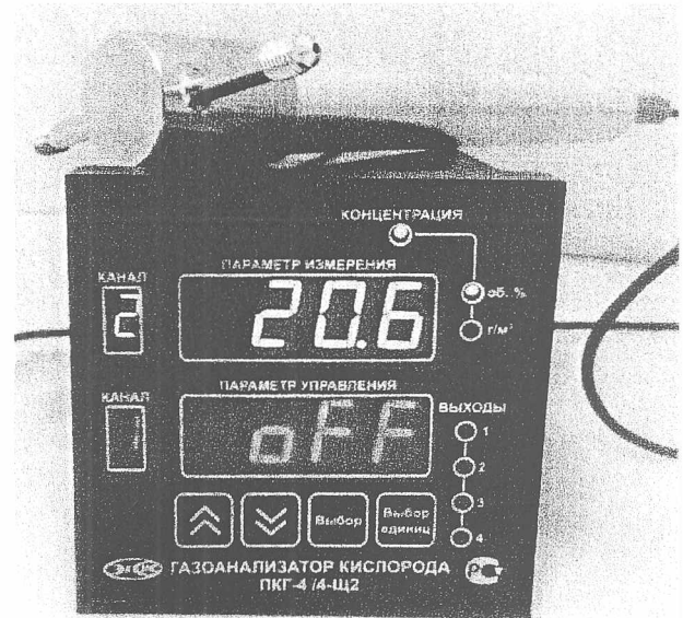
б) исполнение ПКГ-4/4-Щ2-K-4P (четырёхканальный, на фото показан только один измерительный преобразователь)
