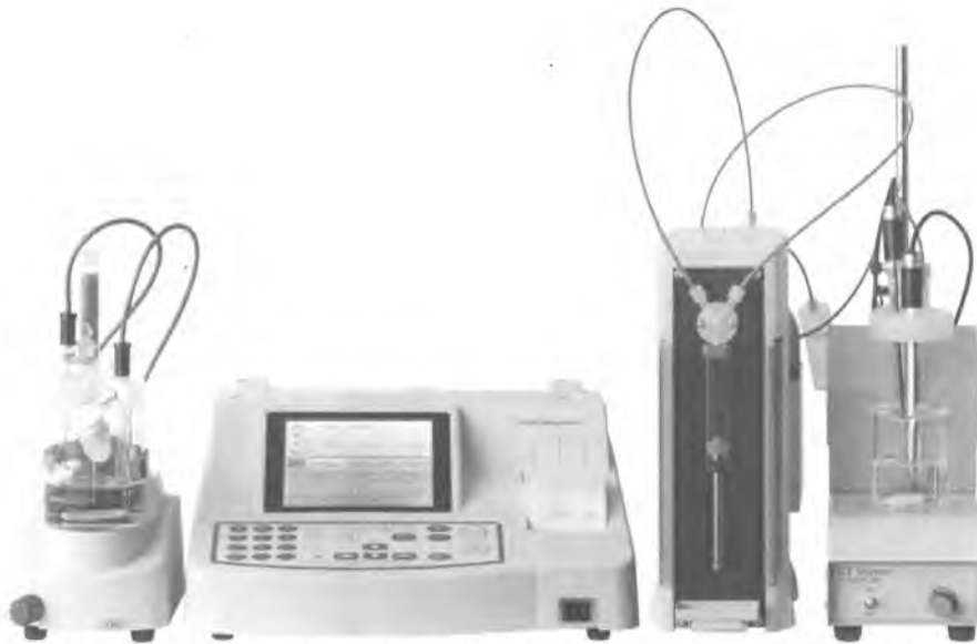
Рис. 3. Внешний вид титратора СА-200 с установленным во втором канале стендом GT Stirrer для потенциометрического титрования
